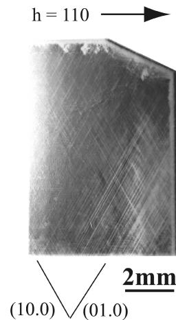
Fig.4 Topographie en transmission du film Zn 0.9 Mn 0.1 O (400nm) : réflexion 110, radiation Mo K\alpha_1 .
